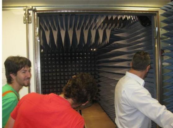
Seguidamente visitamos otro laboratorio dedicado a testear distintos dispositivos microelectrónicos. Nos explicaron las medidas de seguridad que tienen en el instituto y pudimos ver material de laboratorio de grandes prestaciones, como generadores de señales, analizadores de espectros, osciloscopios digitales, una cámara anecoica para el estudio de los diagramas de emisión de antenas, etc.
