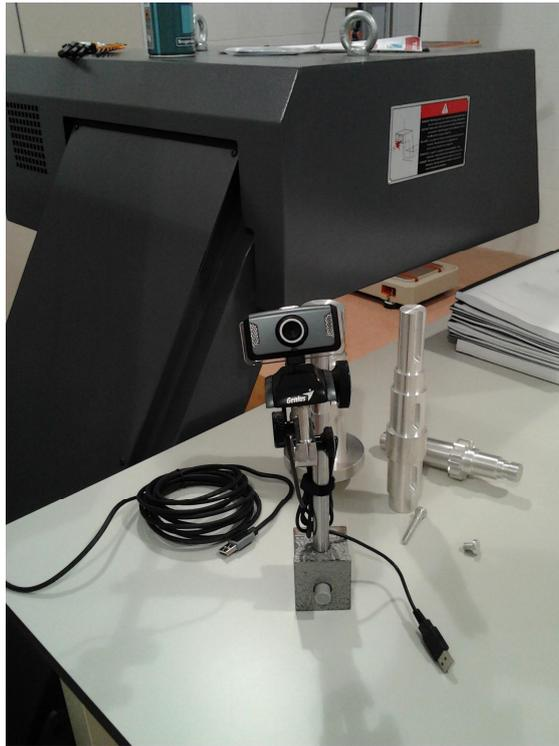
**Figura 1.** Soporte y sistema de fijación de cámara digital.
