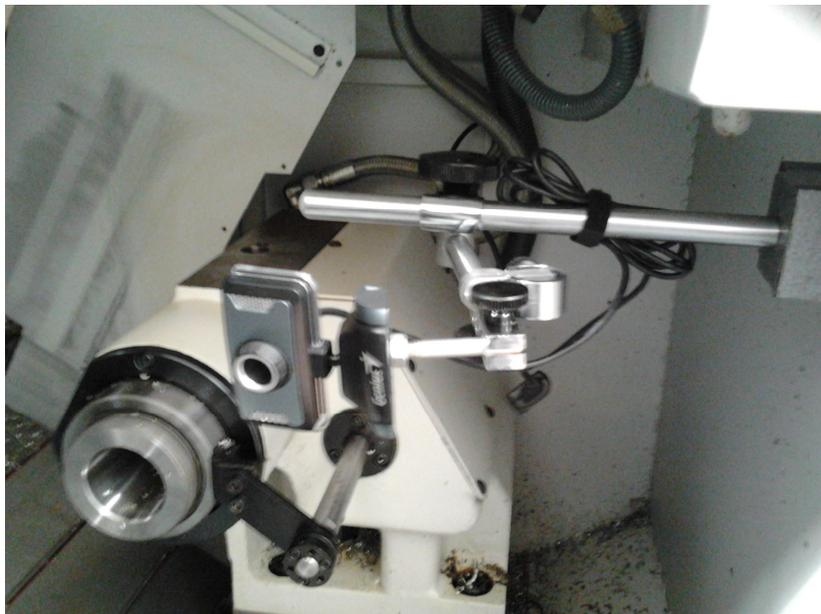
**Figura 2.** Fotografía de dispositivo fijado al torno de CNC. Disposición 1
