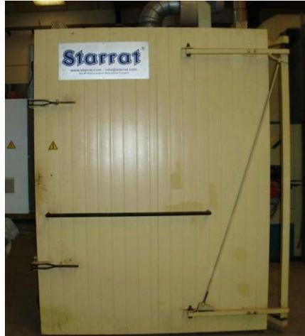
Figura 4 Horno para secado y/o polimerizado
