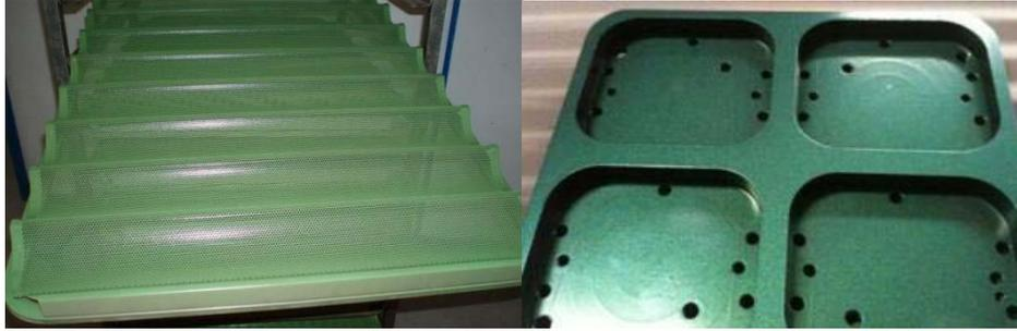
Figura 2. Bandeja para panificación y molde de termoconformado recubierto con dispersión rica en PFA, en un saó y en el otro con dispersión ricas en FEP
