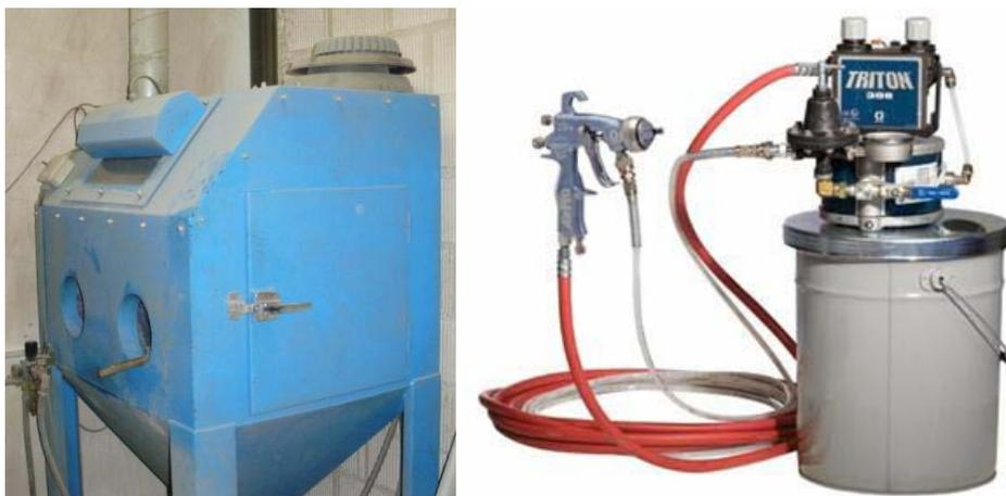
Figura 3. Equipo de chorreado manual (izquierda). Equipo de pintura manual HVLV para aplicación de las formulaciones líquidas (derecha)
