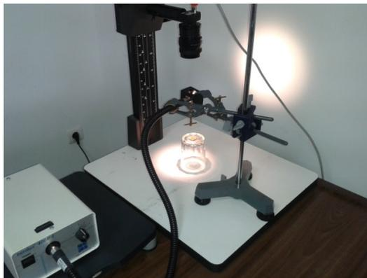
*Ilustración 10: Configuración con iluminación coaxial con espejo beam/splitter*
