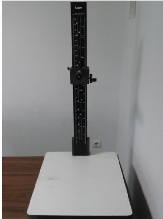
*Ilustración 6: Torreta para sujeción del equipo de adquisición de imágenes.*
