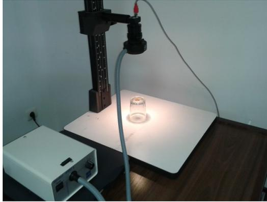
*Ilustración 9: Configuración de iluminación coaxial con anillo de fibra óptica.*
