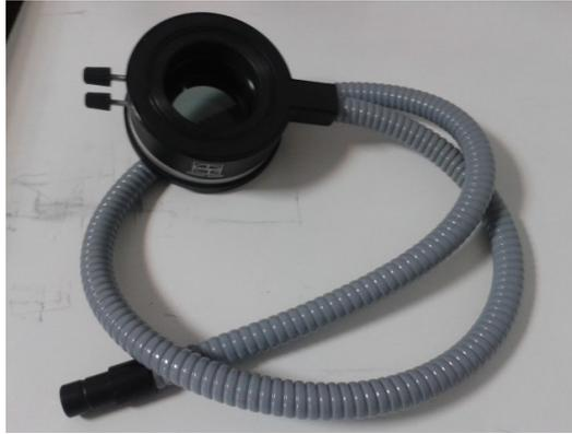
*Ilustración 2: Guía de luz por fibra óptica con anillo para iluminación coaxial Volpi 22179.*
