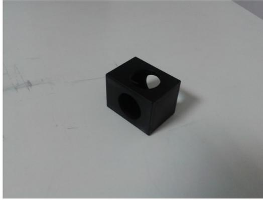
*Ilustración 4: Espejo beam splitter con montura para iluminación coaxial.*
