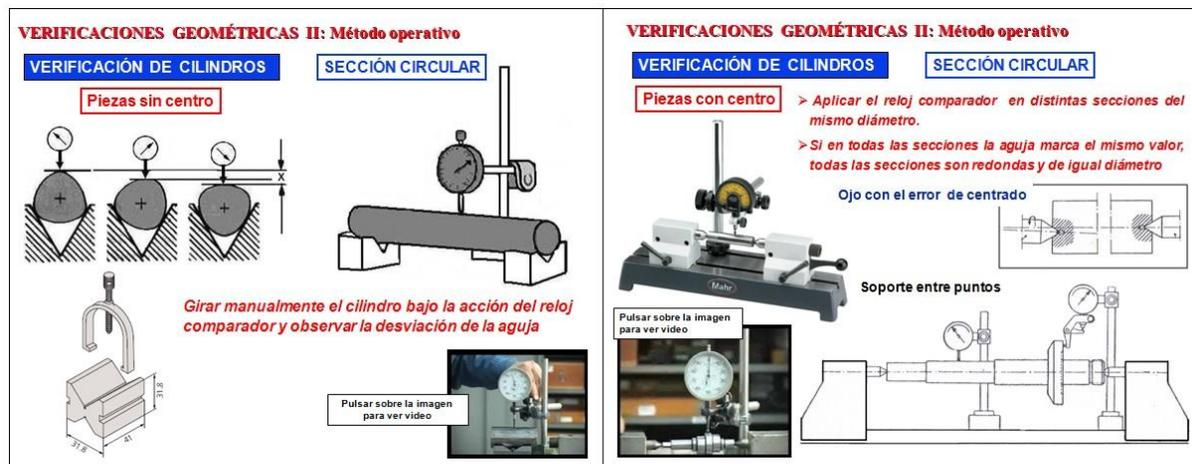
Figura 5: Transparencias método operativo en verificación de cilindros
