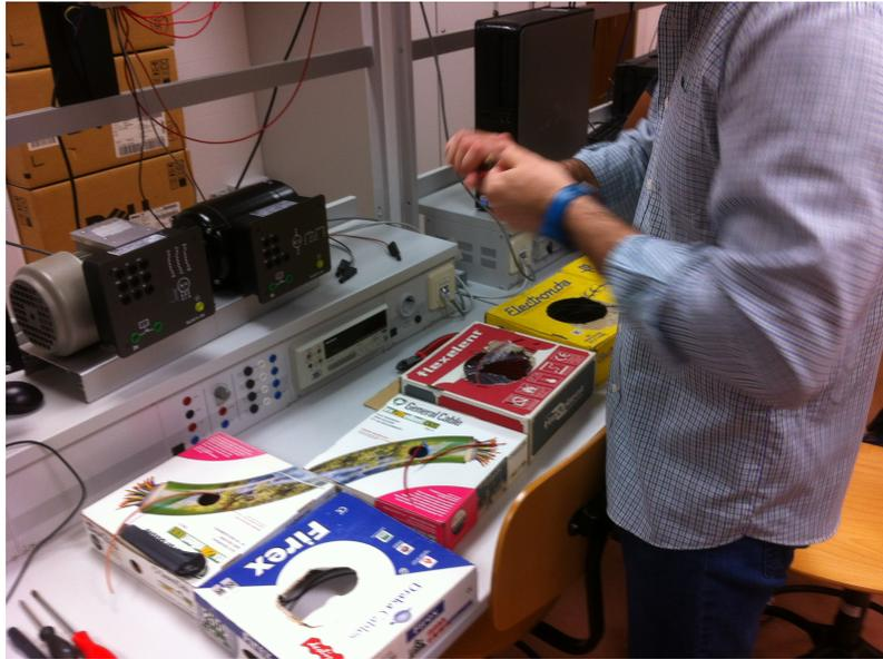
Figura 4: Preparación de las conexiones de los motores al cuadro realizado.
