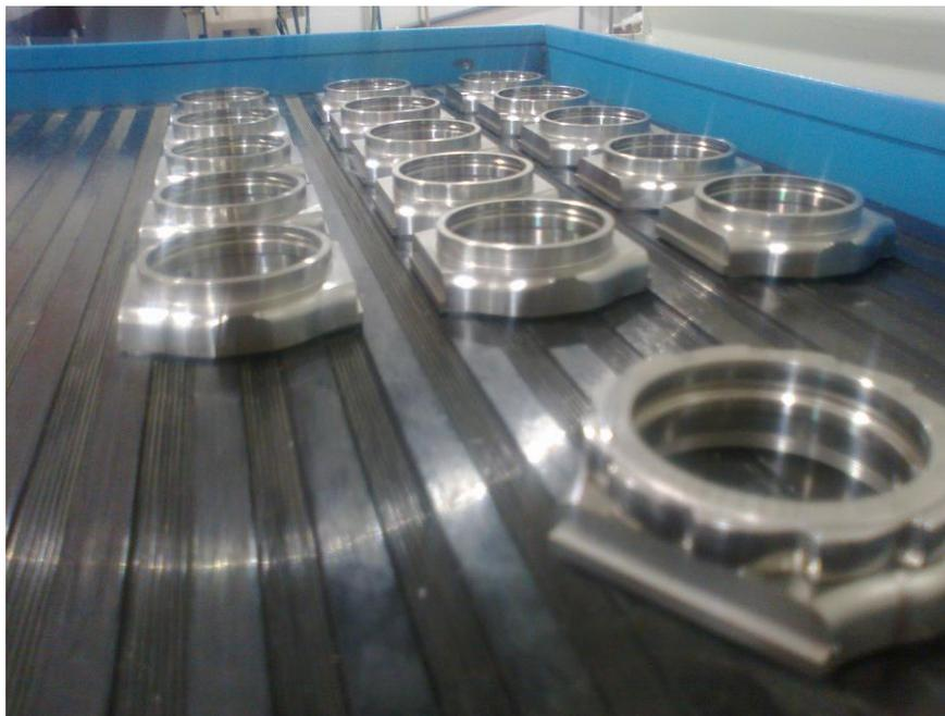
Figura 6: Piezas acabadas con operaciones de torno y fresa CNC.
