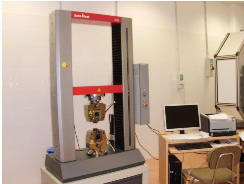
Figura 5. Equipo Zwick Roell Z100 para ensayos de tracción
