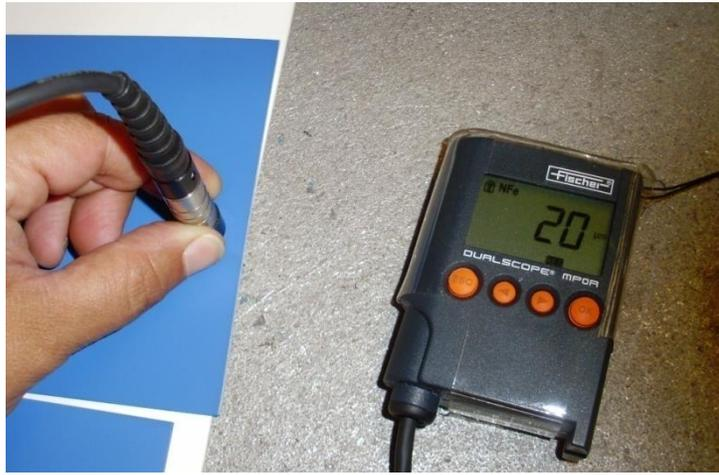
Figura 3. Equipo Fischer Dualscope Mpor de medición de espesores
