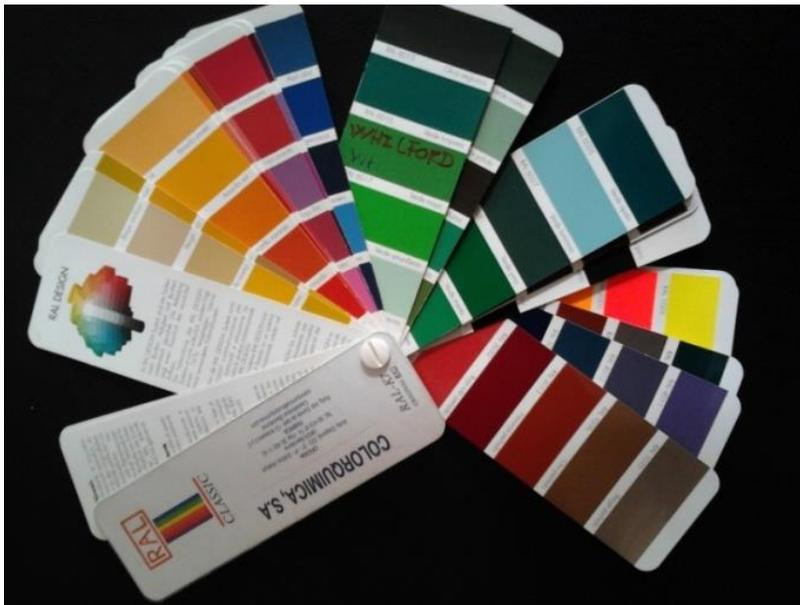
Figura 8. Carta de colores RAL K7 utilizada para determinar el valor RAL de los recubrimientos
