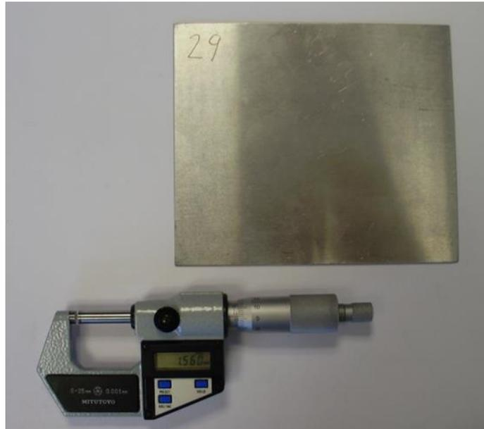
Figura 1. Micrómetro de apreciación 0,001 mm
