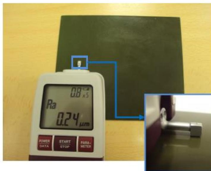
Figura 2. Equipo Mitutoyo Sj-201 para verificación de rugosidad
