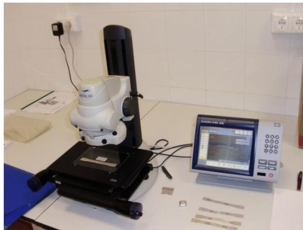
Figura 6. Equipo Mecatronics QS 300 de medición por visión
