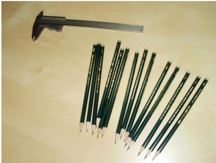
Figura 4. Juego de lápices utilizado en el ensayo de dureza lápiz
