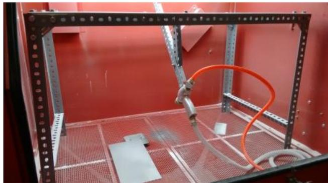
**Figura 6. Estructura para cabina de chorreado**
