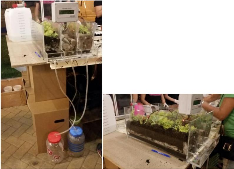
*Figura 3: Modelo a escala de techo verde. A la izquierda se aprecia el sistema de recogida de percolación. A la derecha se aprecian las diferentes capas.*
