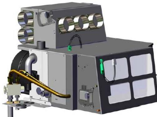
Figura 1 – Unidad Central de Climatización (UCC) de un autobús
