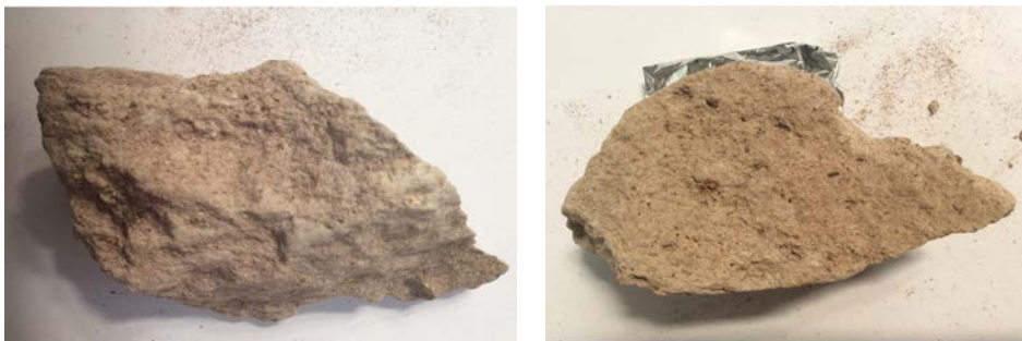
Fig. 7. a) Muestra de ignimbrita (vista deteriorada) de inmueble de Morelia, Mich. b) Muestra de ignimbrita (vista interior) de inmueble de Morelia, Mich. Fuente Aldo Zamudio Pérez, 2017.
